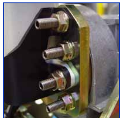
Fig. 3-24 Nieuwe steun stoelhoogteverstelling
