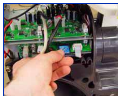
Fig. 5-1 Flashkaart uit aandrijfunit
