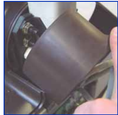
Fig. 3-25 Verwijderen kap voor de hoogteverstelling
