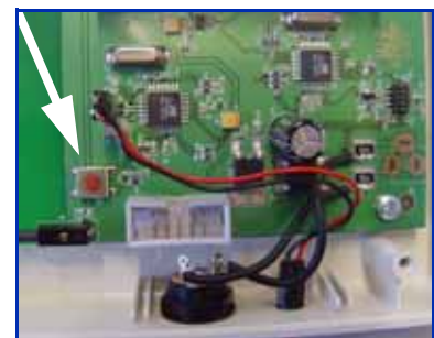
Fig. 4-2 Aanmeldmode starten van repeater
