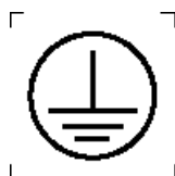
Figuur 5 - Symbool IEC 60417-5019: Beschermende aarde
