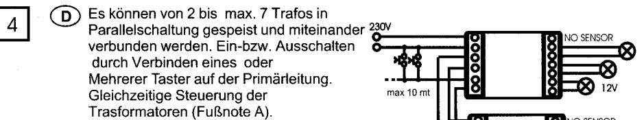
**F** Alimentation et commande de deux ou plusieurs transfos (max 7) connectés en parallèle. Allumage et extinction par un ou plusieurs boutons poussoirs connectés sur la ligne de l'alimentation. Commande simultanée de tous les transfos (note A).
