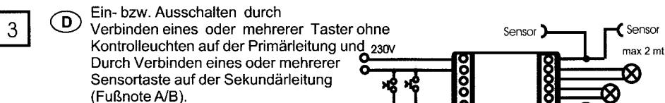
**F** Allumage et extinction par un ou plusieurs boutons poussoirs connectés sur la ligne de l'alimentation et par une ou plusieurs touches sensitives connectées sur le secondaire (note A/B).
