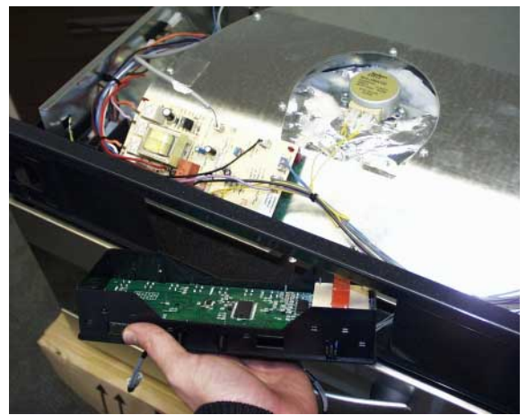
Afbeelding.: Invoerelektronica in gemonteerde toestand en het wegnemen na het ontgrendelen.
