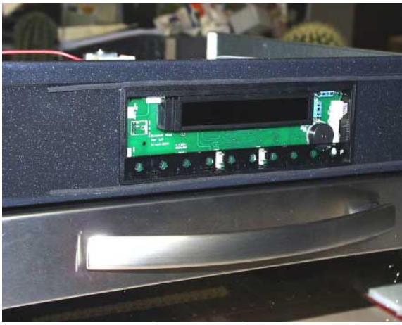
Afbeelding.: Invoerelektronica in gemonteerde toestand en het wegnemen na het ontgrendelen.
