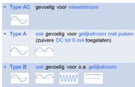
Figuur 1: Soorten stroom waarvoor de types diff. gevoelig zijn.
